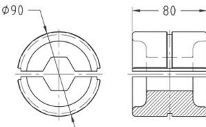
Stampi circolari a chiave esagonale, adatti a comprimere giunti in alluminio ed in acciaio.
